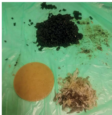
33. sz. ábra A lépekből főzött minikorong, a sonkolysalak és a korong alján található szürke réteg elkülönítése az analízisek előtt (a kép a kis léptékű kísérletek egyikének mintáit ábrázolja)
