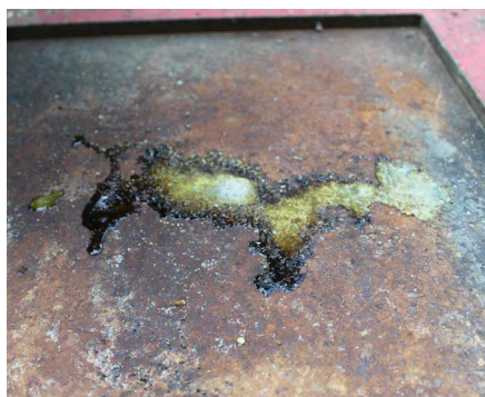
14. sz. ábra A lapkákról lecsorgó oxálsavas lé megmarja a fém alkatrészeket
